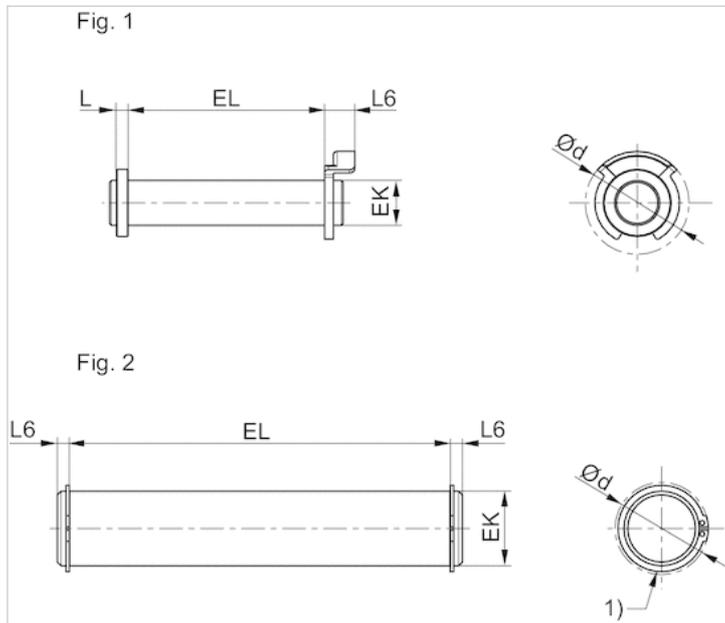
1) Sicherungsring DIN 471
