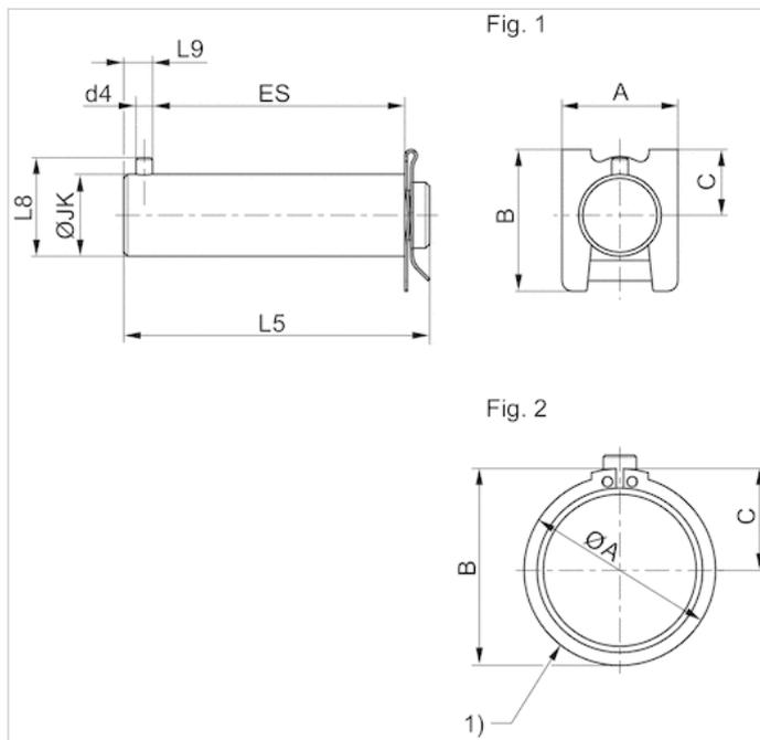
1) Sicherungsring DIN 471
