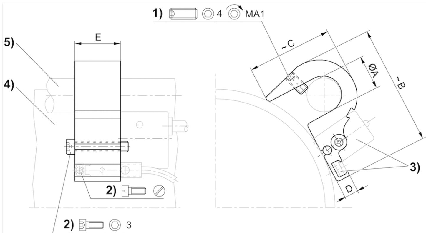
1) Klemmgewindestift 2) Befestigungsschraube für Sensor 3) Sensor 4) Zylinderprofil 5) Zuganker
