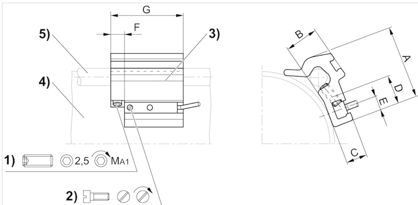
1) Klemmgewindestift 2) Befestigungsschraube für Sensor 3) Sensor 4) Zylinderprofil 5) Zuganker
