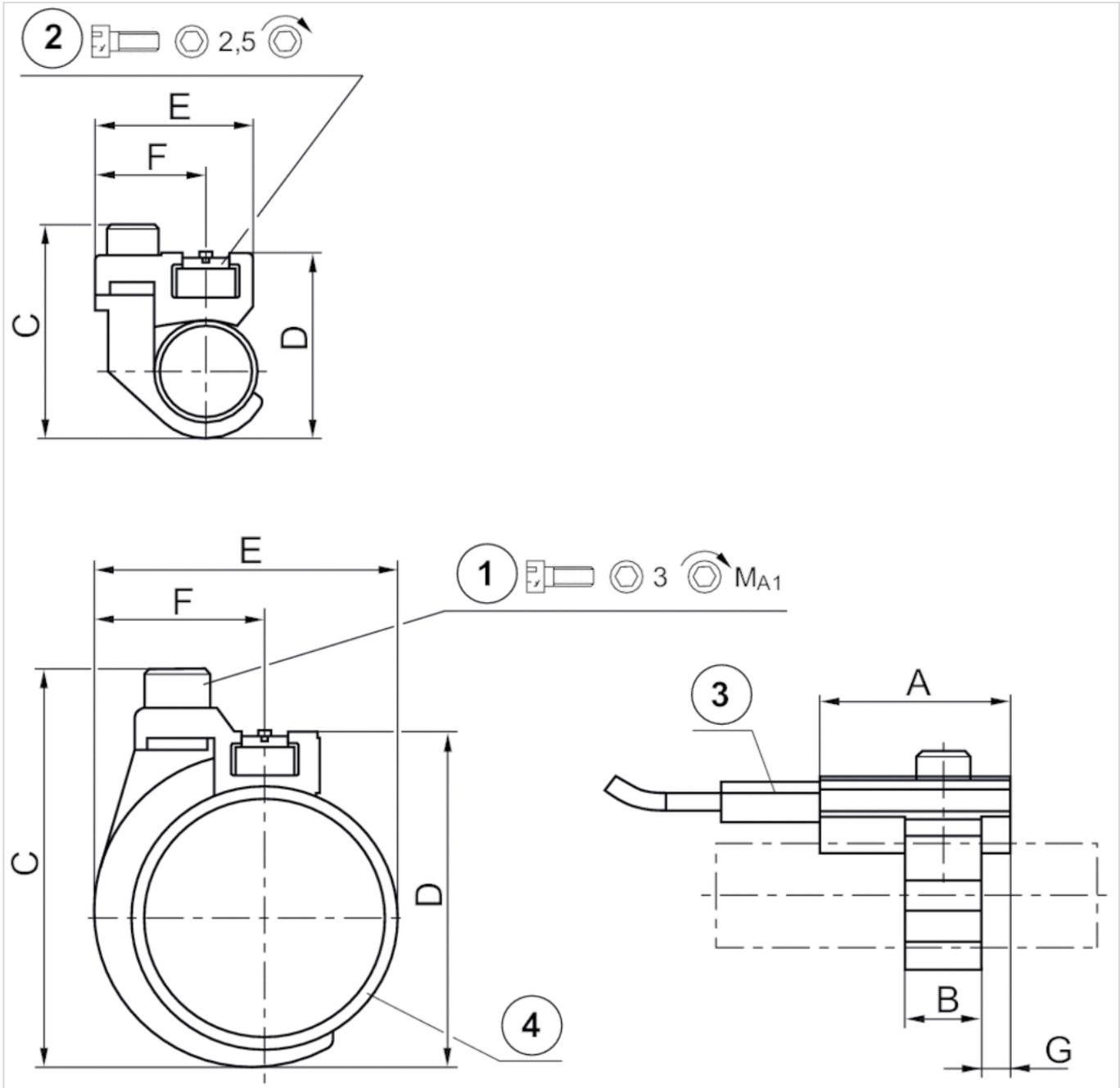
1) 固定螺钉 2) 传感器固定螺钉 3) 传感器 4) 气缸外形
