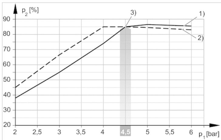
1) =  $\varnothing$  Düse 1,0 mm 2) =  $\varnothing$  Düse 1,5 mm
