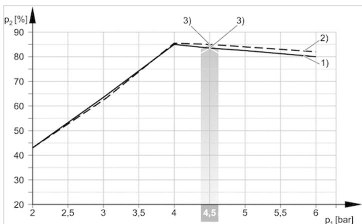
1) = Ø Düse 0,5 mm 2) = Ø Düse 0,7 mm
