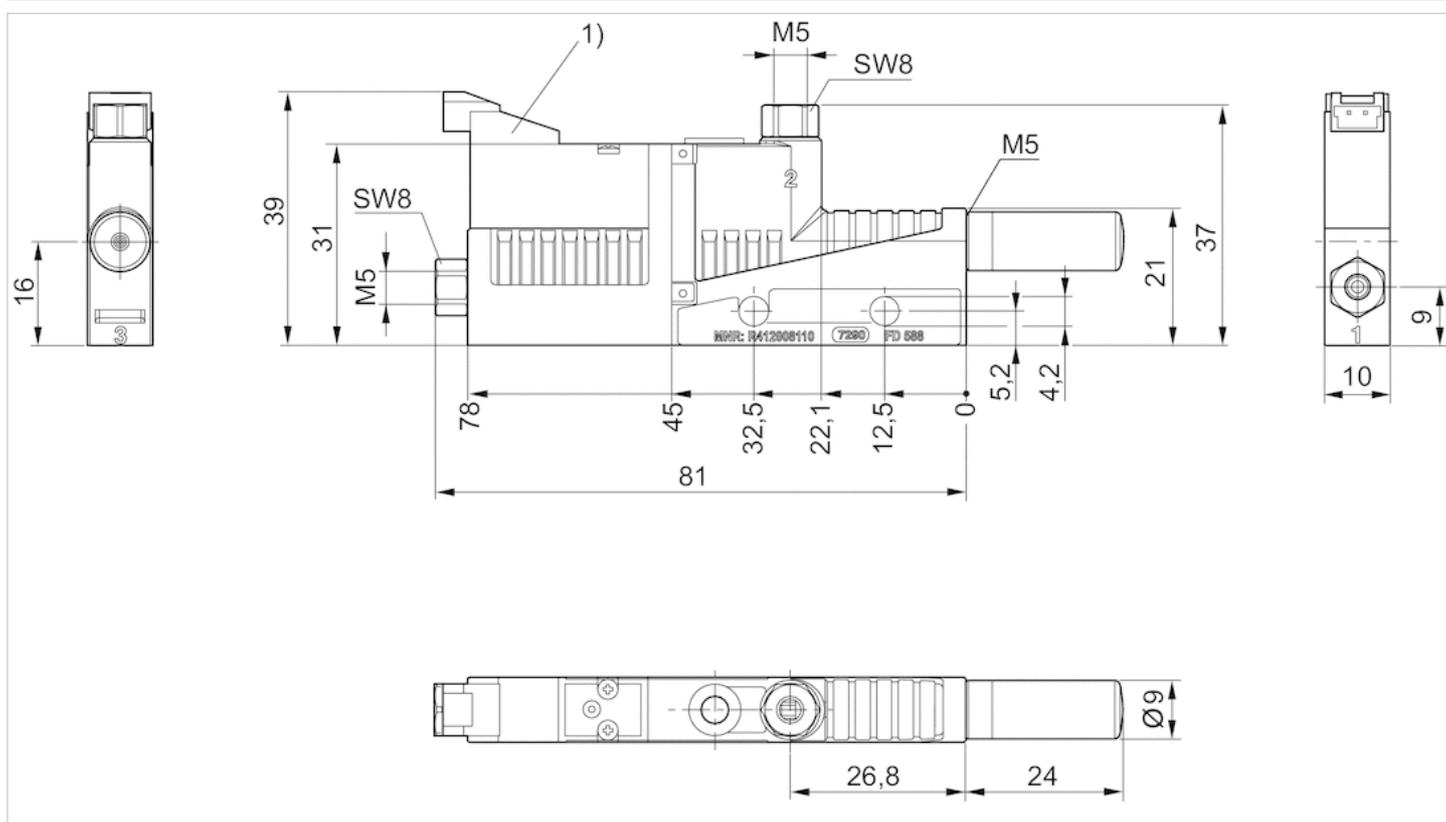
1) Magnetventil Vakuum EIN/AUS
