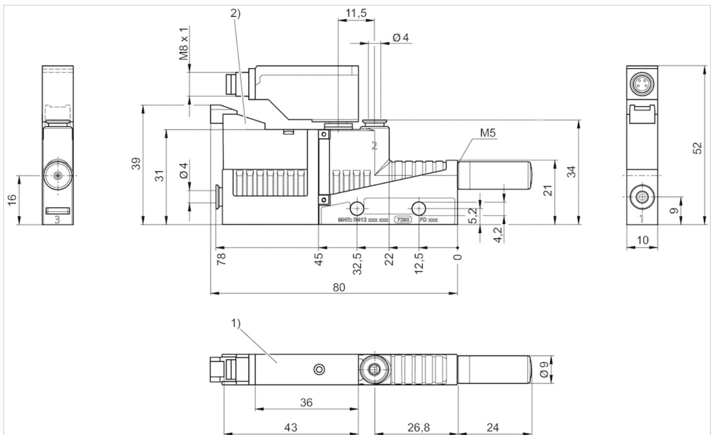
1) Vakuumschalter ist drehbar und auswechselbar
