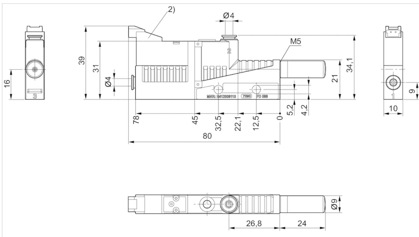
2) Magnetventil Vakuum EIN/AUS
