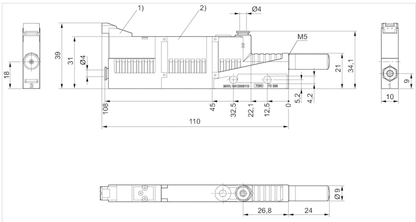
1) Magnetventil Vakuum EIN/AUS
