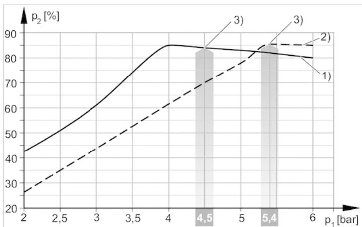
1) = Ø Düse 0,5 mm 2) = Ø Düse 0,7 mm
