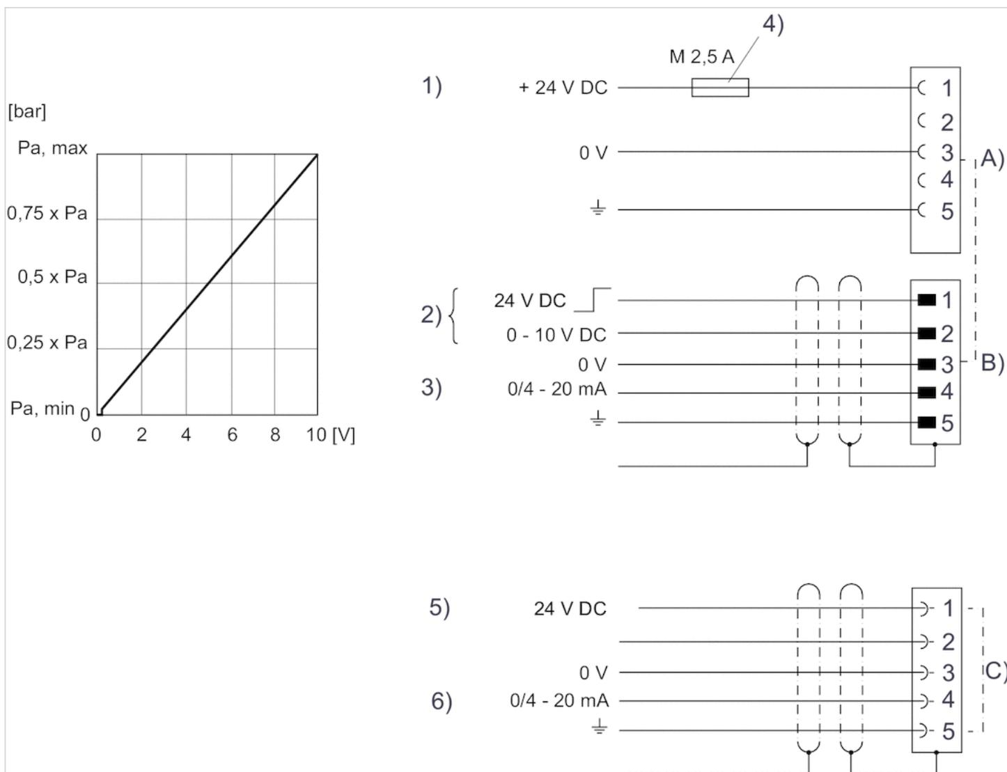
1) Versorgungsspannung 2) Schaltausgang (Pin 1) und Sollwert (Pin 2) sind auf 0 V bezogen. 3) Istwert (Pin 4) ist auf 0 V bezogen (externe Bürde min. 10 kOhm) 4) Die Versorgungsspannung muss mit einer externen Sicherung M 2,5 A abgesichert werden. Zur Gewährleistung der EMV sind Stecker X2A und 2XN über ein geschirmtes Kabel anzuschließen. Bei anliegender Versorgungsspannung von 1 MOhm wird der Spannungseingang hochohmig.
