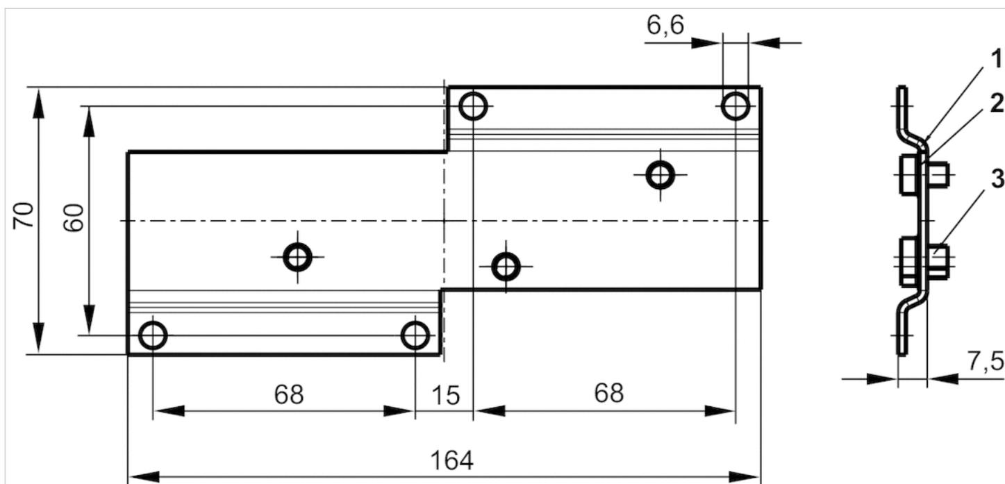
1) Montageblech 2) Schraube DIN 6912 3) Zahnscheibe DIN 6797-A
