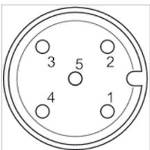
Pin 1: 信号+ UB, 颜色: 棕色 Pin 2: 信号: Out 2 (PNP)/ 类似的 4 - 20 mA, 颜色: 白色 Pin 3: 信号: 0 V, 颜色: 蓝色 Pin 4: 信号: Out 1 (PNP), 颜色: 黑色 Pin 5: 信号: FE, 颜色: 灰色
