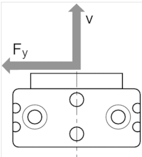
Maximal zulässige Radialkraft  $F_y$  [N] in Abhängigkeit von  $v$  [mm] RCM 12
