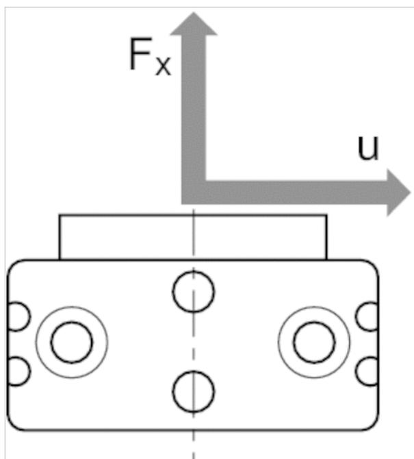
Maximal zulässige Axialkraft  $F_x$  [N] in Abhängigkeit von  $u$  [mm] RCM 12
