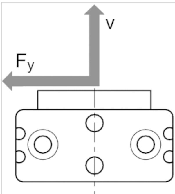
Maximal zulässige Radialkraft  $F_y$  [N] in Abhängigkeit von  $v$  [mm] RCM 6 - 12
