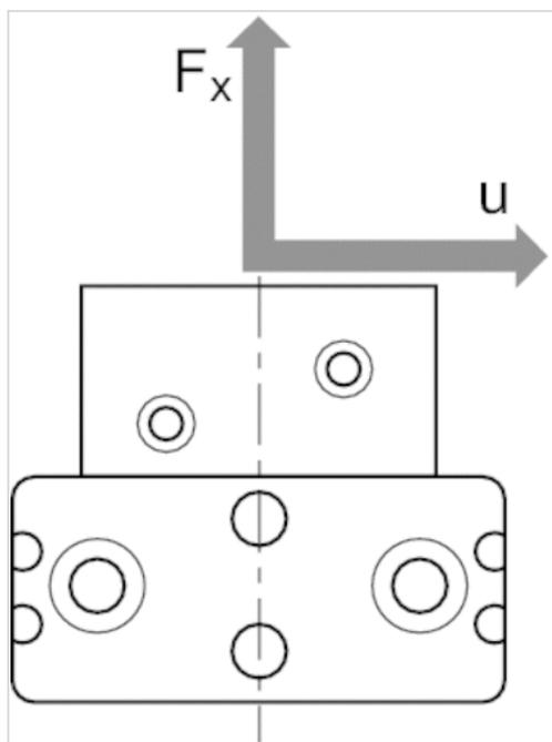
Maximal zulässige Axialkraft  $F_x$  [N] in Abhängigkeit von  $u$  [mm] RCM 12
