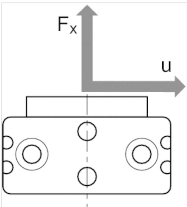
Maximal zulässige Axialkraft  $F_x$  [N] in Abhängigkeit von  $u$  [mm] RCM 6 - 12
