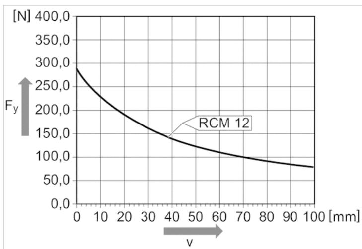
Maximal zulässige Axialkraft  $F_x$  [N] in Abhängigkeit von  $u$  [mm]
