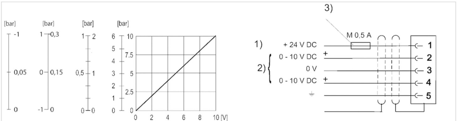
1) 供电电压 2) 实际值 (引脚 4) 和额定值 (引脚 2) 引入 0 V。
