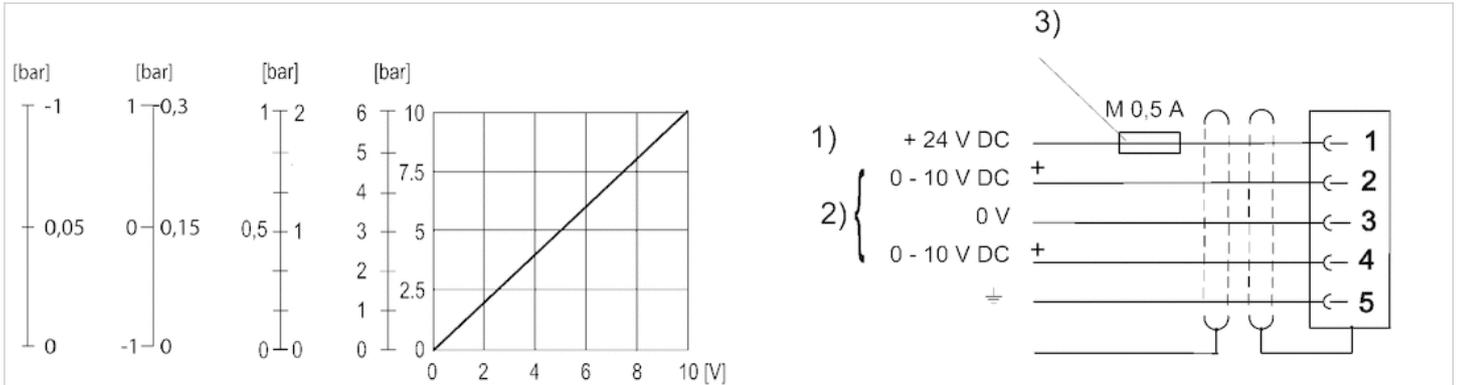
1) 供给电压 2) 实际值 ( 引脚 4 ) 和额定值 ( 引脚 2 ) 引入 0 V。
