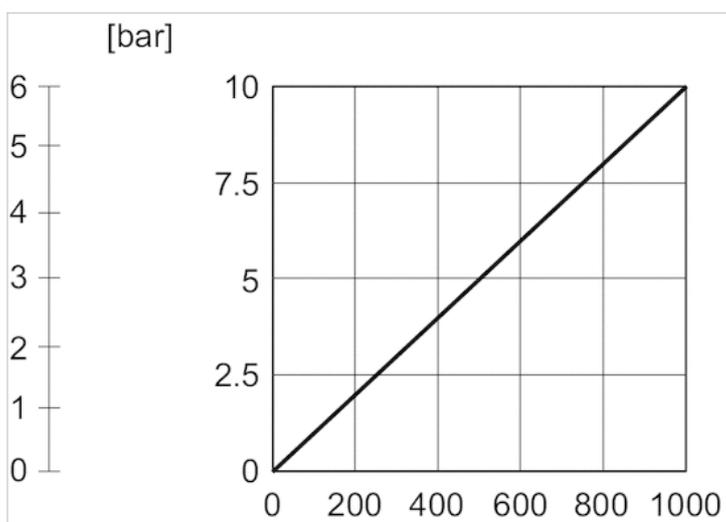
调节器具备分辨率为 10 Bit (Bit 0 ... 9)用于连续的额定值和连续的实际值：额定值范围和实际值范围为 10 bar 规格 (范围 0 到 1000)，分辨率为 10 mbar。
