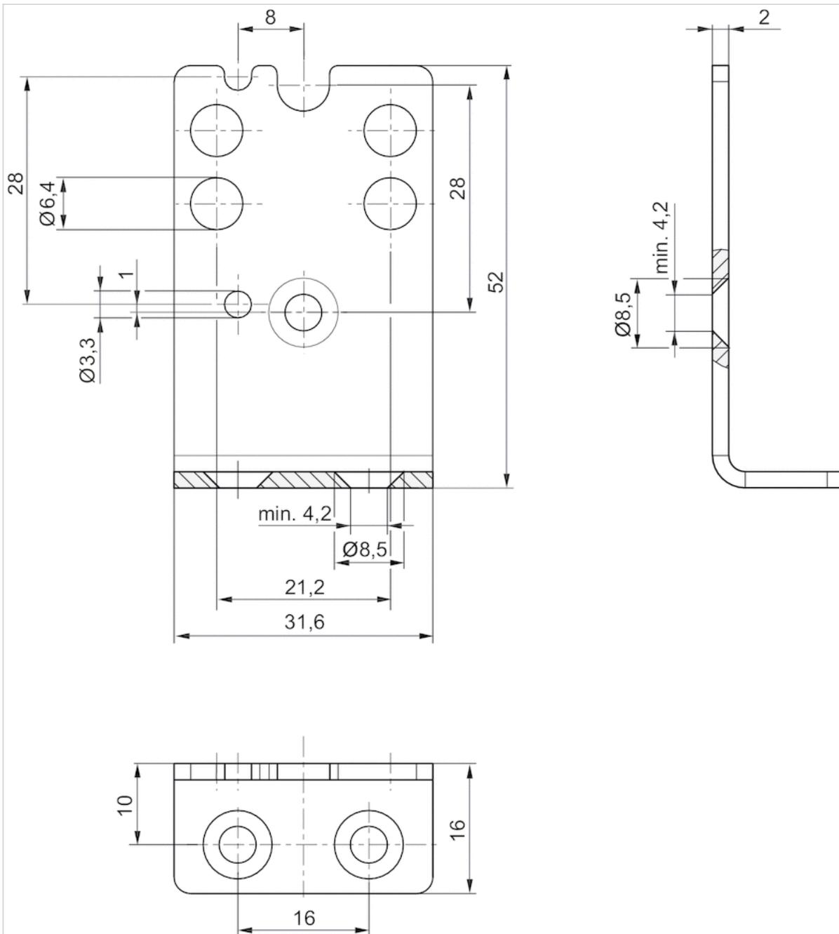
供货范围包含 2 个符合 DIN 7991- A4 M4X8 的埋头螺栓用于固定至调压阀，系列 AV。
