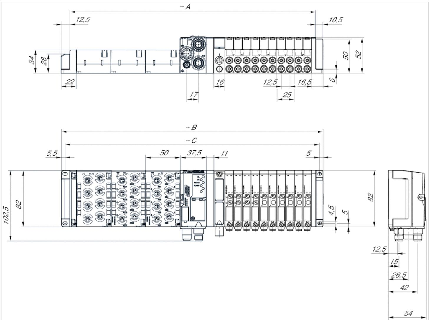
$A = \text{阀位数量} \times 12.5 \text{ mm} + \text{供给板数量} \times 16 \text{ mm} + \text{输入/输出数量} \times 50 \text{ mm} + 64 \text{ mm}$
