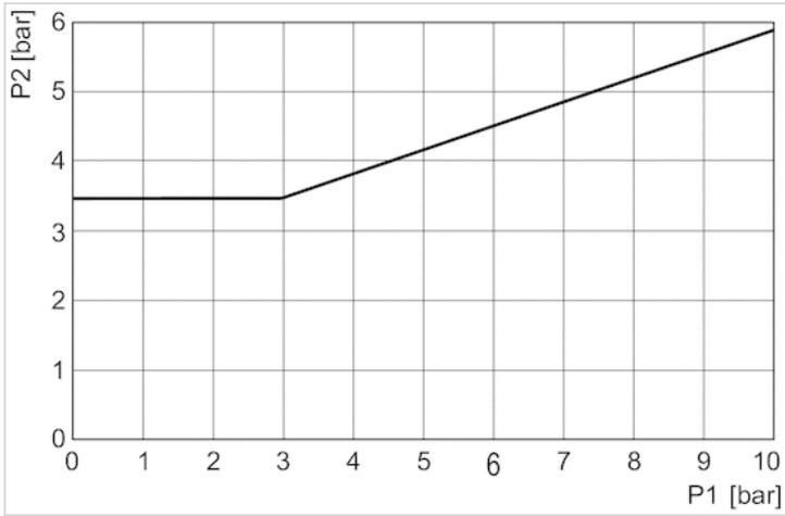
p1 = 接口 2 和 4 上的压力 , p2 = 开关压力
